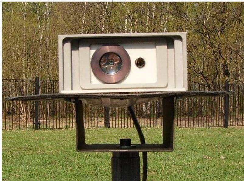
Внешний вид датчика. Видна резиновая пластина, выступающая за габариты датчика, для защиты датчика при падении треноги.
